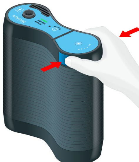
Per rimuovere la batteria dalla fessura, premere entrambi i pulsanti blu ai lati della batteria e sollevare.
