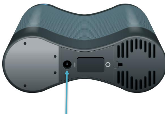
Puerto de CA ubicado al lado del botón de encendido
